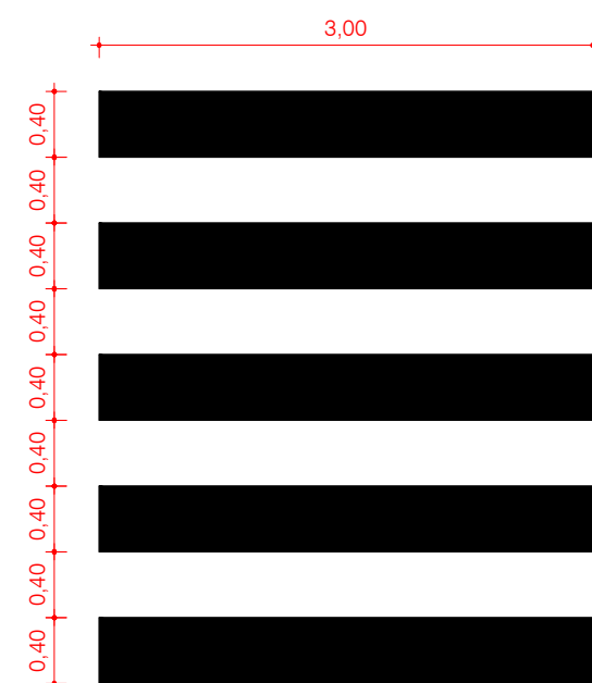
03 DETALHAMENTO FAIXA DE PEDESTRE ESC.: 1/50
