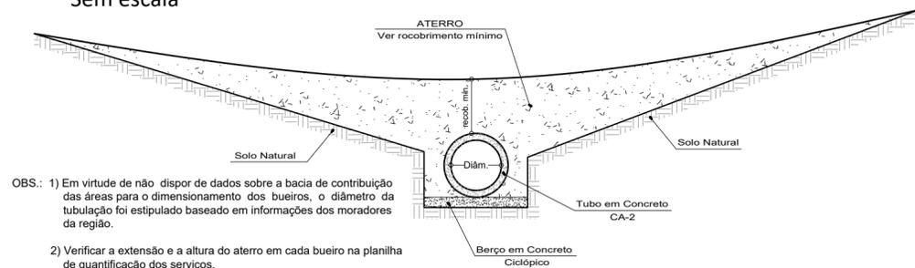
OBS.: 1) Em virtude de não dispor de dados sobre a bacia de contribuição das áreas para o dimensionamento dos bueiros, o diâmetro da tubulação foi estipulado baseado em informações dos moradores da região.
