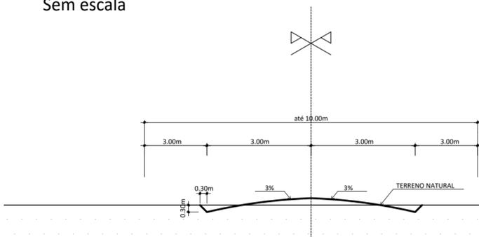
**SEÇÃO PADRÃO COM REVESTIMENTO PRIMÁRIO**
