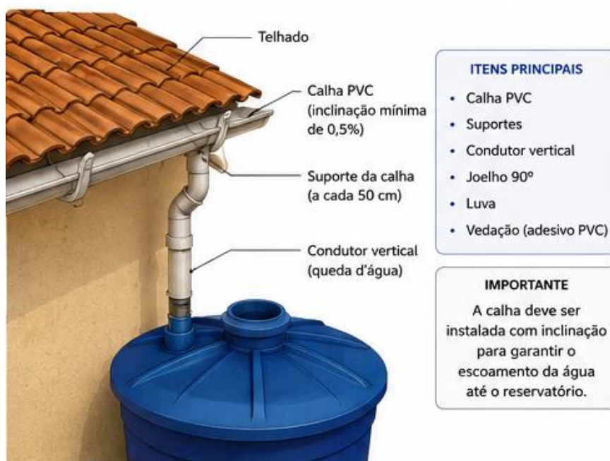
Figura 1: Instalação do sistema de captação de água de chuva
