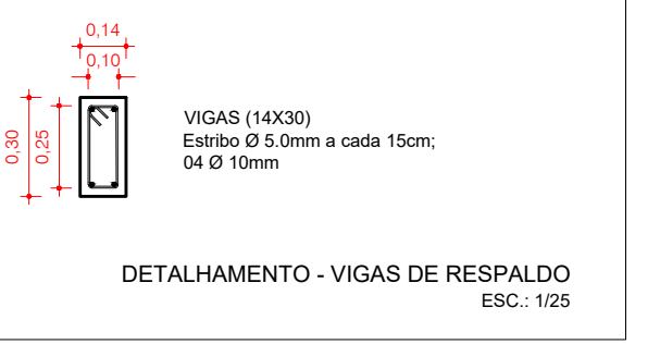
DETALHAMENTO - VIGAS DE RESPALDO ESC.: 1/25
